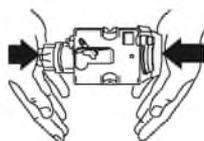
Если трудно вставить заварочный узел, необходимо (передвставлением) исправить его размер, нажав на два рычага, как показано на рисунке.
